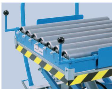
I Rollenbahn mit handbetätigter Schwerkraftklinke
