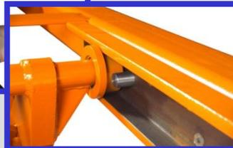
Verschleißteile wie Laufrollen und Laufschiene sind leicht wechselbar und auf eine hohe Lebensdauer ausgelegt . Alle Lager sind gut zugänglich
