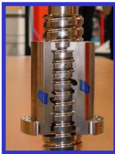
**Flexlift Spindelhubtische** werden mit hochwertiger Spindeltechnologie ausgestattet . Je nach Einsatzfall werden die Spindeln gerollt , geschält oder geschliffen. Tragfähigkeit und Lebensdauer einer Kugelumlaufspindel werden über die Anzahl und Größe der sich im Umlauf befindlichen Kugeln bestimmt.
